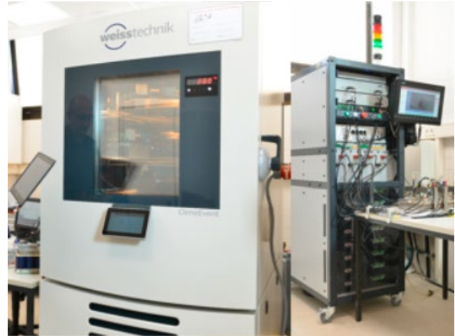
Bild 10: Klimakammer und Powercycler im Zuverlässigkeitslabor
