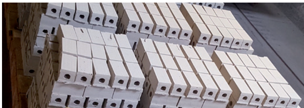
Abb. 12.2: Gepresste Batzen zum Schamottebrand (Quelle: KTS).
