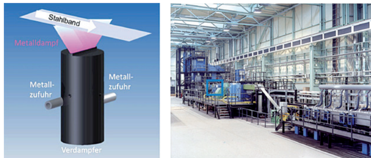
Abbildung 4.1.7.2 Schematische Darstellung der neuen PVD-Hochleistungsquelle; der ungefähre Einbaubereich der Quelle in der Bandversuchsanlage wird durch das blaue Quadrat auf dem Foto angedeutet
