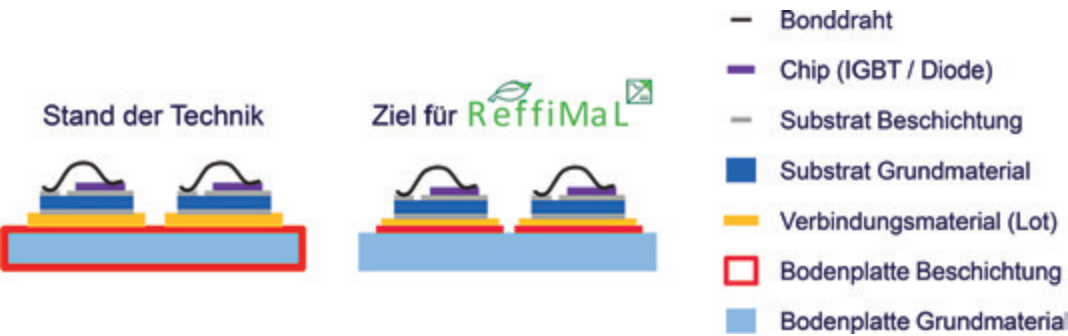
Abbildung 3.1.18.2 Querschnitt durch ein typisches Leistungsmodul und schematische Darstellung der Projektziele
