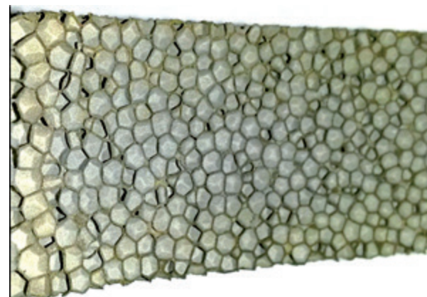
Abbildung 3.1.4.3 PZS-Bogensegment vor dem Fügen in bauteilähnlicher Geometrie
