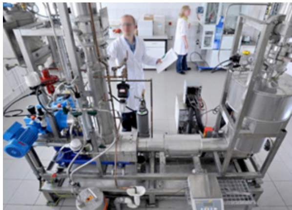
5.1.7.1 Technikums Reaktor zur Hydroformylierung (Miltitz Aromatics GmbH)
