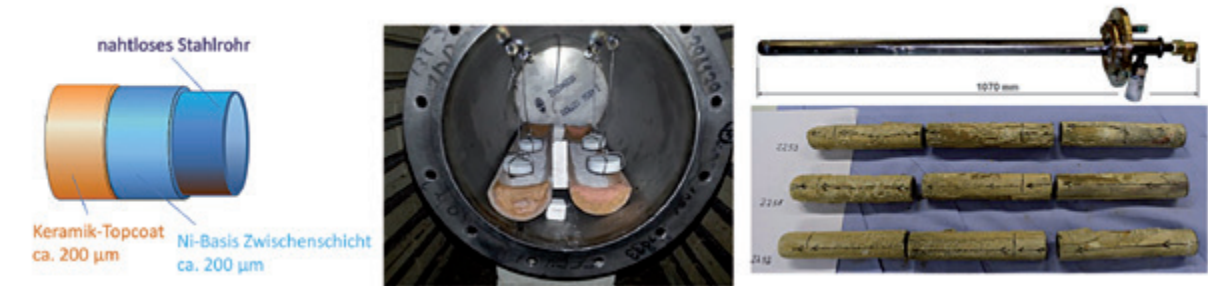
Abbildung 4.1.10.1 Schichtkombination auf Wärmetauscherrohr (links), beschichtete Massivproben im Laborversuch (Mitte) und Sondenrohre für in-line Untersuchungen vor (unbeschichtet, rechts oben) und nach dem Kraftwerkseinsatz (aschebelegt, rechts unten).
