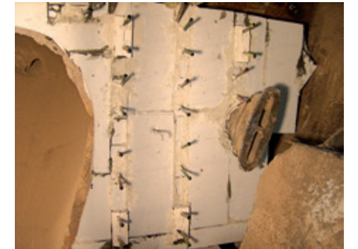
Abbildung 4.1.2.1 Links: Unbeständiges Auskleidungssystem bestehend aus (von links nach rechts) Feuerbeton, Wärmedämmschicht, Ofenaußenblech. Rechts: Beständiges Auskleidungssystem zu Projektende
