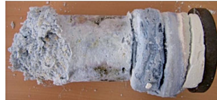
Abbildung 4.1.2.1 Links: Unbeständiges Auskleidungssystem bestehend aus (von links nach rechts) Feuerbeton, Wärmedämmschicht, Ofenaußenblech. Rechts: Beständiges Auskleidungssystem zu Projektende
