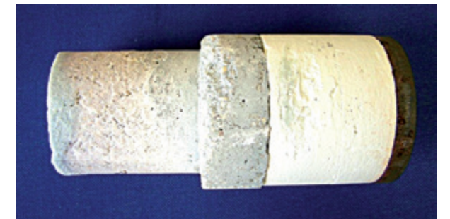
Abbildung 4.1.2.2 Testfeld im Zementofen in Karsdorf
