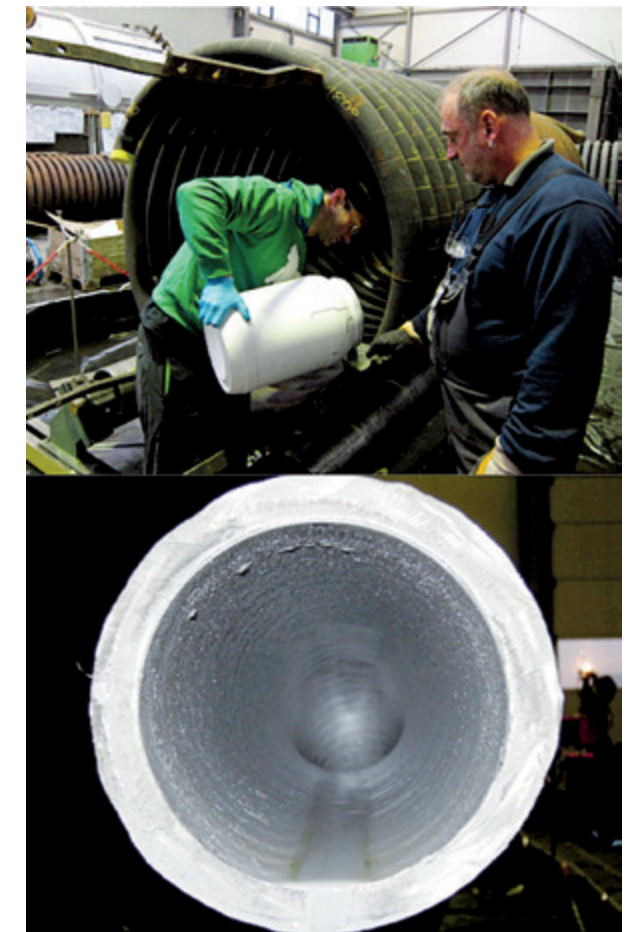
Abbildung 4.1.9.2 Aufbringung des Slurrys auf den Abhitzekessel; Coating direkt nach dem Aufbringen
