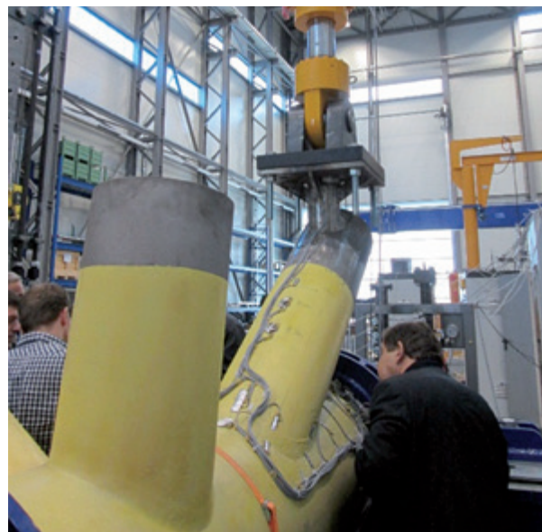
Abbildung 4.1.6.5 Demonstratorknoten im Wechsellast Prüfaufbau beim IWES
