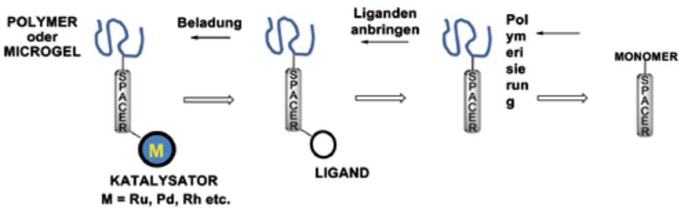
Abbildung 5.1.6.1 Übersicht über die Möglichkeiten zur Funktionalisierung der Polymere und Mikrogele.
