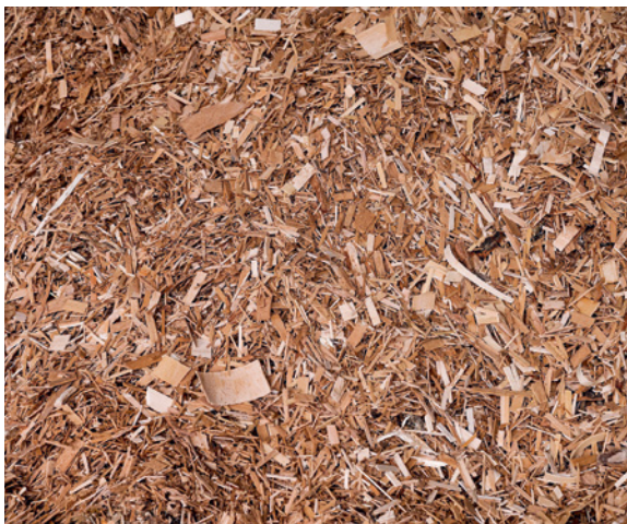
Blick in die Zukunft: Der Ofen des Heizwerks wird mit Abfällen und Resten aus der Furnierproduktion betrieben.
