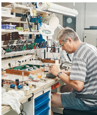
Produktion Ein Mitarbeiter setzt Bauteile für ein Mikroskop zusammen.
