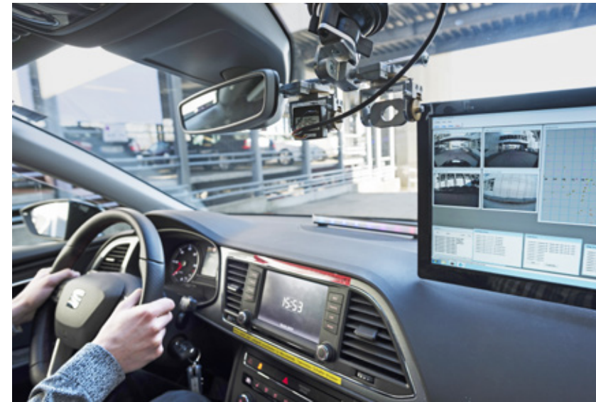
Prototyp Um den Algorithmus zu optimieren, geht das Auto voller Kameras auf Testfahrten.
