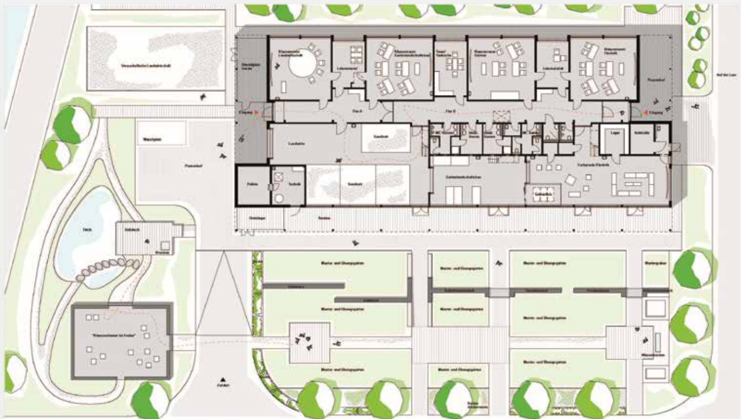
Grundriss Erdgeschoss mit Außenanlagen
