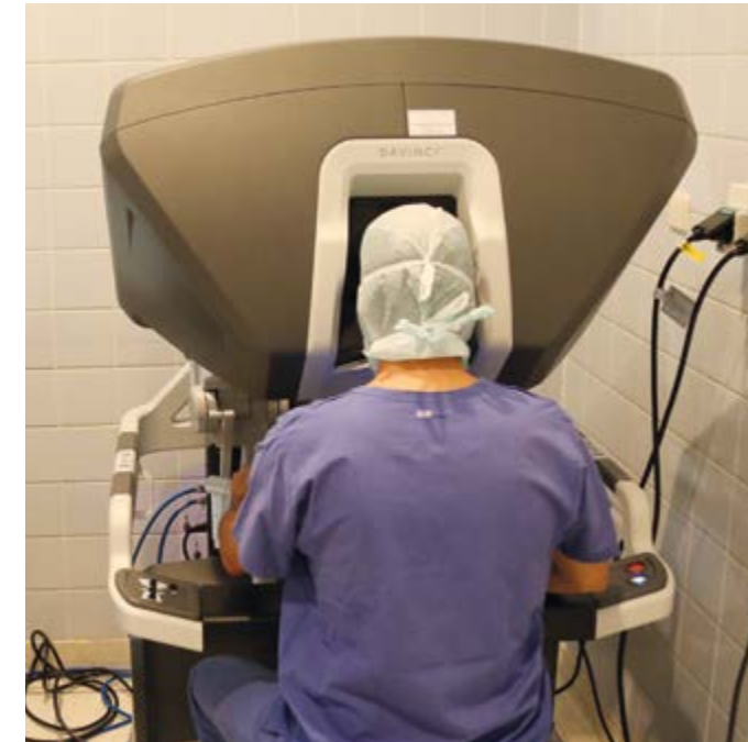
Beim Da Vinci-Operationssystem sitzt der Chirurg an einer Steuerkonsole, von der aus er über das Videosystem eine Full-HD-3D-Sicht bekommt und die vier Arme des Roboters bewegt.
