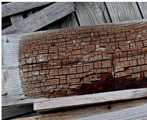
Abb. 29 Ein Brett wurde von einem Braunfäule-Pilz besiedelt und zerfällt in kleine Klötzchen (Würfelfäule).
