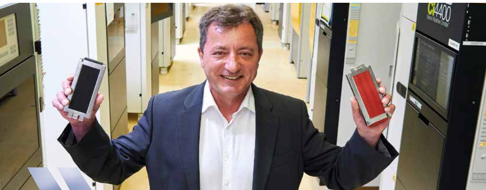
Harte Tests: Jörn Jahnke zeigt zwei Materialproben vor dem Testlauf. In den Anlagen können bis zu 113 Proben auf einem Prüfgestell gleichzeitig bestrahlt werden.
