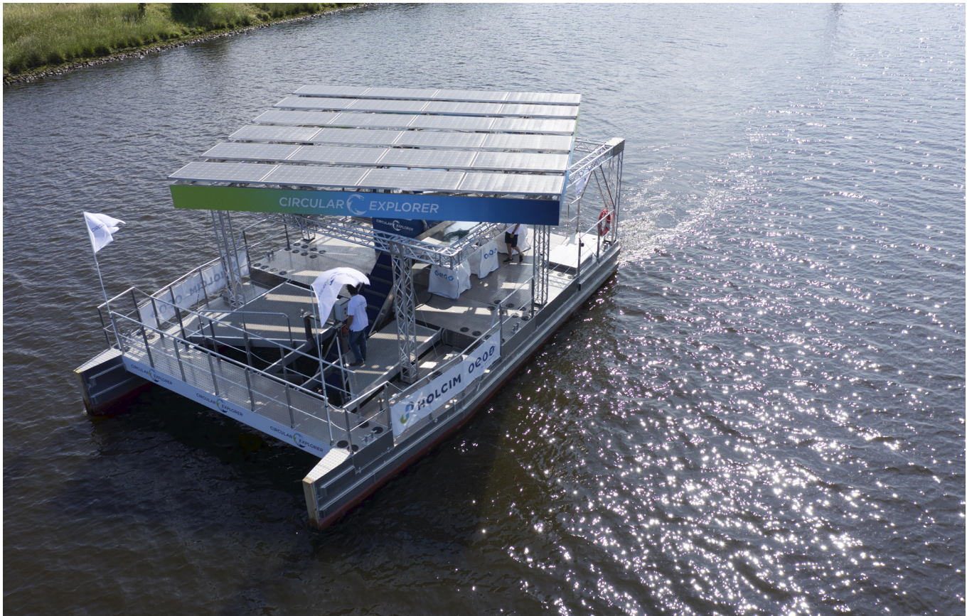
Der Solarstrom-getriebene Katamaran "Circular Explorer". Die neueste und modernste Waffe im Kampf gegen den Plastikmüll.
