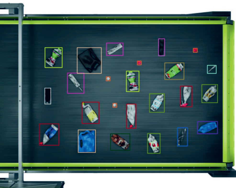
KI eröffnet neue Möglichkeiten für eine sichere Kunststoffsortierung
