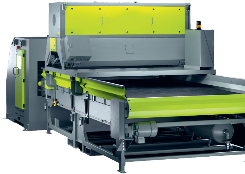
Mittels integrierter Sensoren ordnen Sortiermaschinen das vorhandene Material in sortenreine Kunststoffströme
