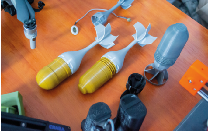
Prototyp einer Polymer-Raketenbombenspitze, die mit Material extrusion gedruckt wurde. © Marina Grigorivna/ Shutterstock
