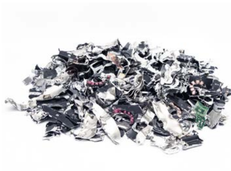
Sicherheitsstufe H4: Datenträger vielfach in kleine Partikel zerteilt.
