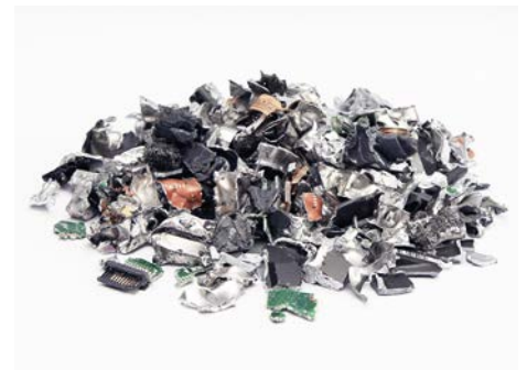
Sicherheitsstufe H-5: Datenträger vielfach in kleinste Partikel zerteilt.
