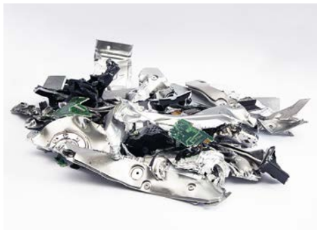
Sicherheitsstufe H3 Security: Datenträger verformt und mehrfach zerteilt.
