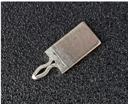
Abbildung 5.1: Darstellung der beiden geprüften Pin geometrien; (a) FlexPin mit offener Pinspitze, (b) EloPin mit geschlossener Pinspitze
