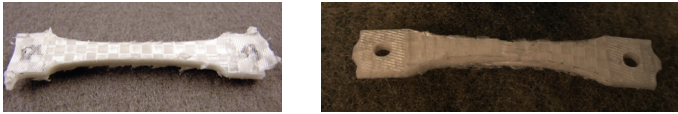
Abbildung 4.8: links: Delamination der Spannflächen; rechts: optimierte Probengeometrie nach Abb. 4.7 mit mittigem Versagen des Prüfkörpers
