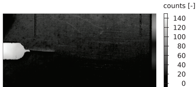
Abbildung 2.10: Schlechte Ausleuchtung am Beispiel einer metallischen CT-Probe [Gmb17b]
