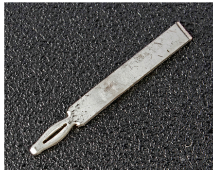
Abbildung 5.1: Darstellung der beiden geprüften Pin geometrien; (a) FlexPin mit offener Pinspitze, (b) EloPin mit geschlossener Pinspitze
