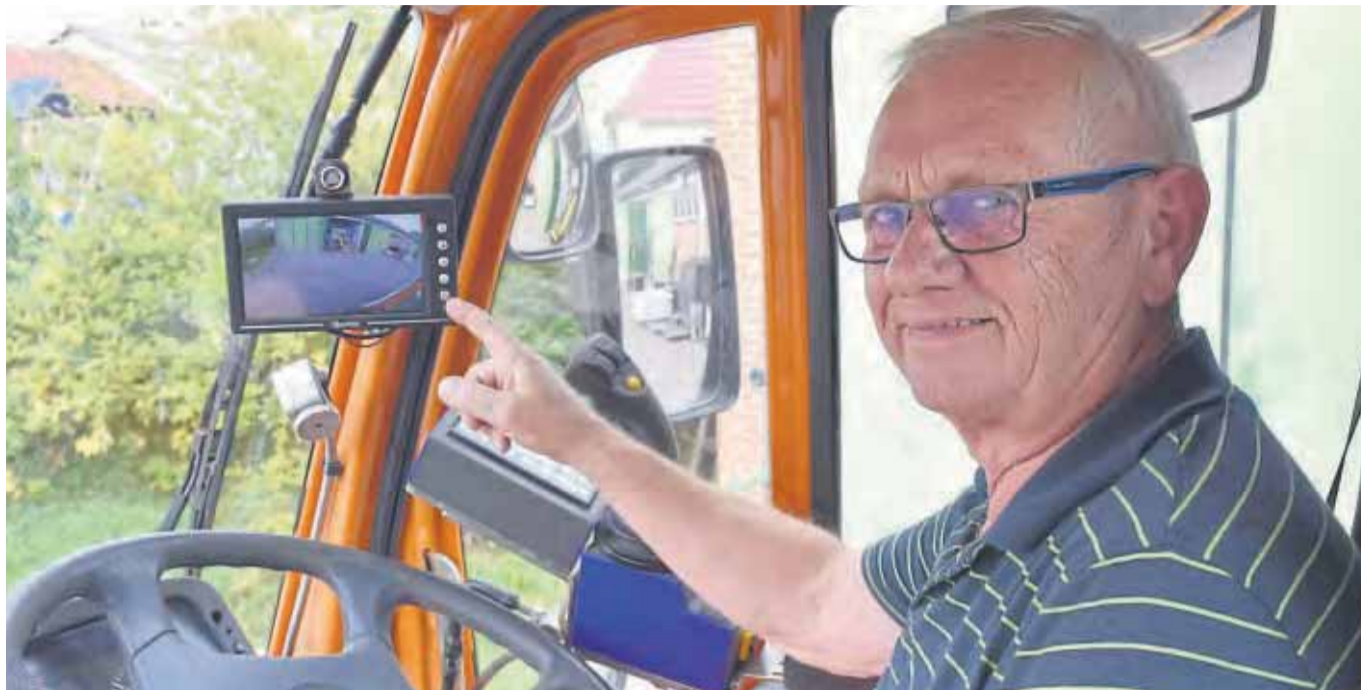
Kann Leben retten: Hessen-Mobil-Mitarbeiter Klaus Schröder kann den toten Winkel seines Fahrzeuges jetzt per Video einsehen. Damit sinkt die Gefahr, Fußgänger oder Radfahrer zu übersehen. FOTO: NICO BECK/NH
