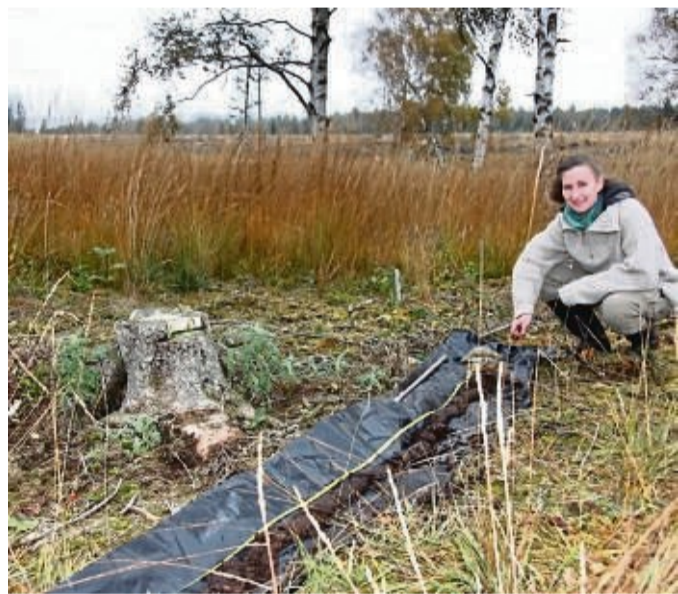
Blick in die Moor-Geschichte: Maria Aljes (Nordwestdeutsche Forstliche Versuchsanstalt) zeigt eine Bohrung in den Torf-Untergrund im Federbruch. Die zusammen gut drei Meter langen Bohrstücke dokumentieren 9000 Jahre Moor-Wachstum.
