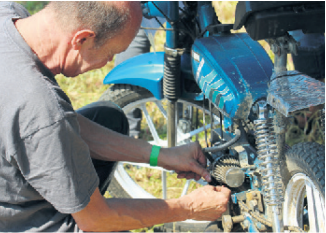
Setzte sich immer wieder zu: Der Luftfilter an der Herkules vom Team Ackerfräse. Hier am Schrauben: Burkhard Kramer.
