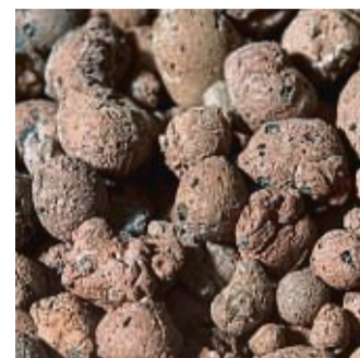
Die Tonkügelchen in Hydrokultur-Systemen sind ein Naturprodukt, das bei etwa 1200 Grad gebrannt wird.
