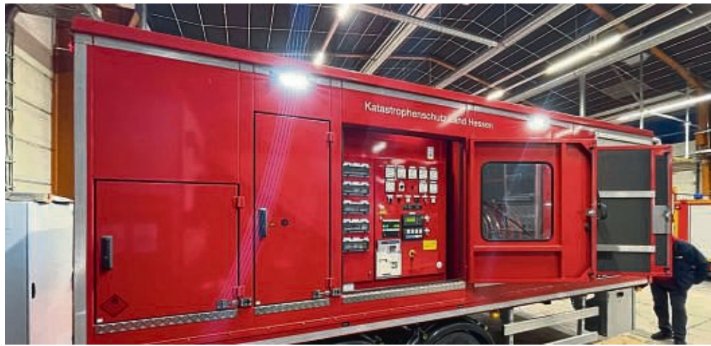
Steht für den Ernstfall bereit: Das Land Hessen hat für den Katastrophenschutz einen mobilen Stromerzeuger bei der Feuerwehr Witzzenhausen stationiert.
