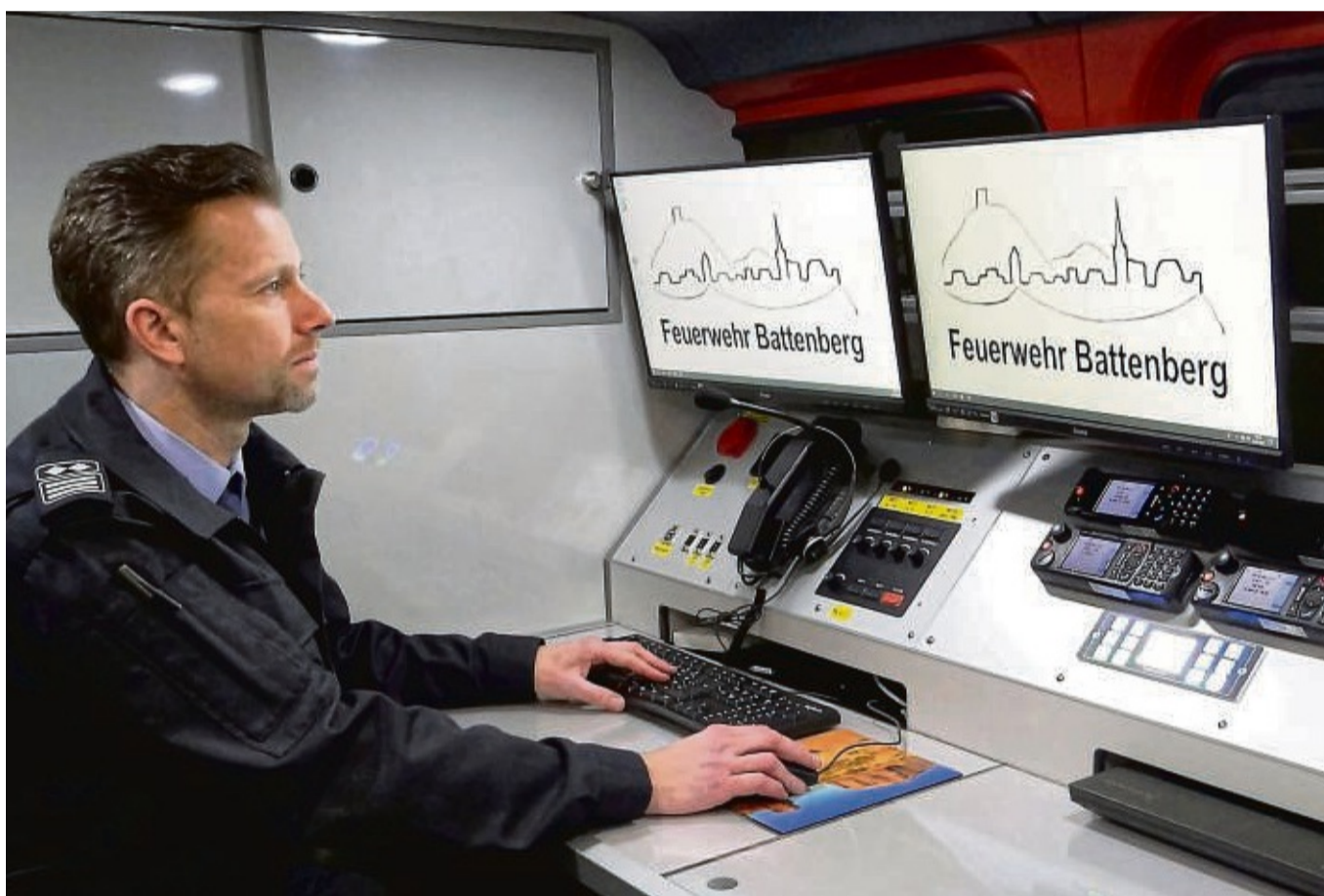
Modern: Battenbergs Stadtbrandinspektor Michael Wenzel positioniert sich im neuen Einsatzleitwagen. Das ELW-1 ist ein mit Computer-Technik ausgestattetes Büro für Kommunikations- und Dokumentations-Aufgaben. FOTOS: PETER BIENHAUS
