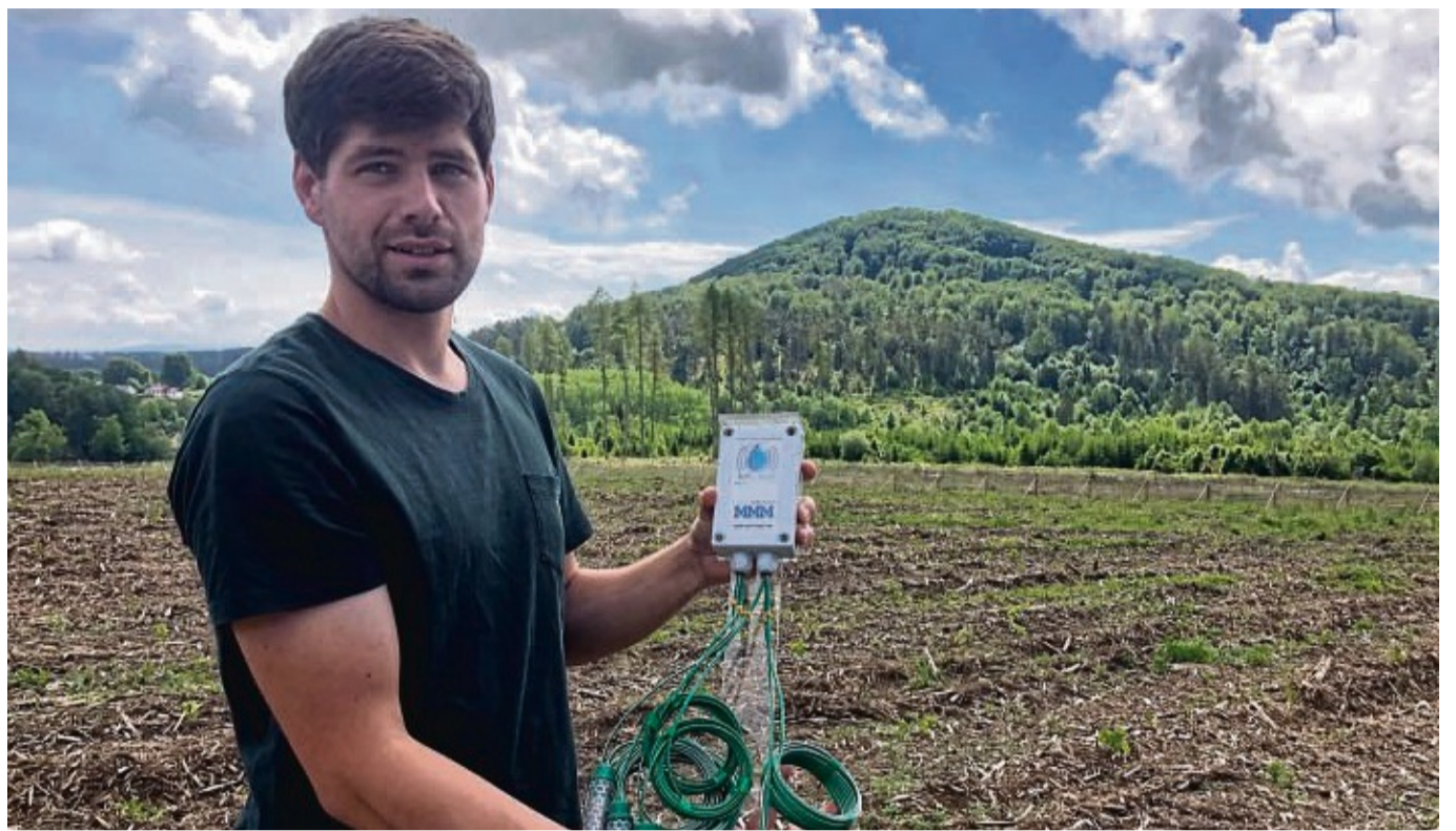
Sender und Sensoren: Förster Dominik Tamke von der Nordwestdeutschen Forstlichen Versuchsanstalt misst mit dieser Apparatur auf einer Fläche mit jungen Eichen bei Ippinghausen die Feuchtigkeit im Boden. FOTO: ANTIJE THON
