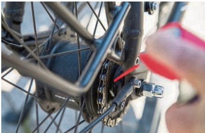
Ein guter Tropfen: Mit speziellem Kettenöl läuft die Kette nach der Reinigung wieder geschmiert. FOTO: CHRISTIN KLOSE/DPA-TMN
