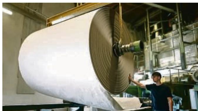
Im Papierwerk in Diemelstadt produziert Papier Sprick umweltfreundliche Verpackungslösungen auf Altpapierbasis. Das hergestellte Recyclingpapier wird auf Mutterrollen gewickelt. FOTO: PAPIER SPRICK GMBH
