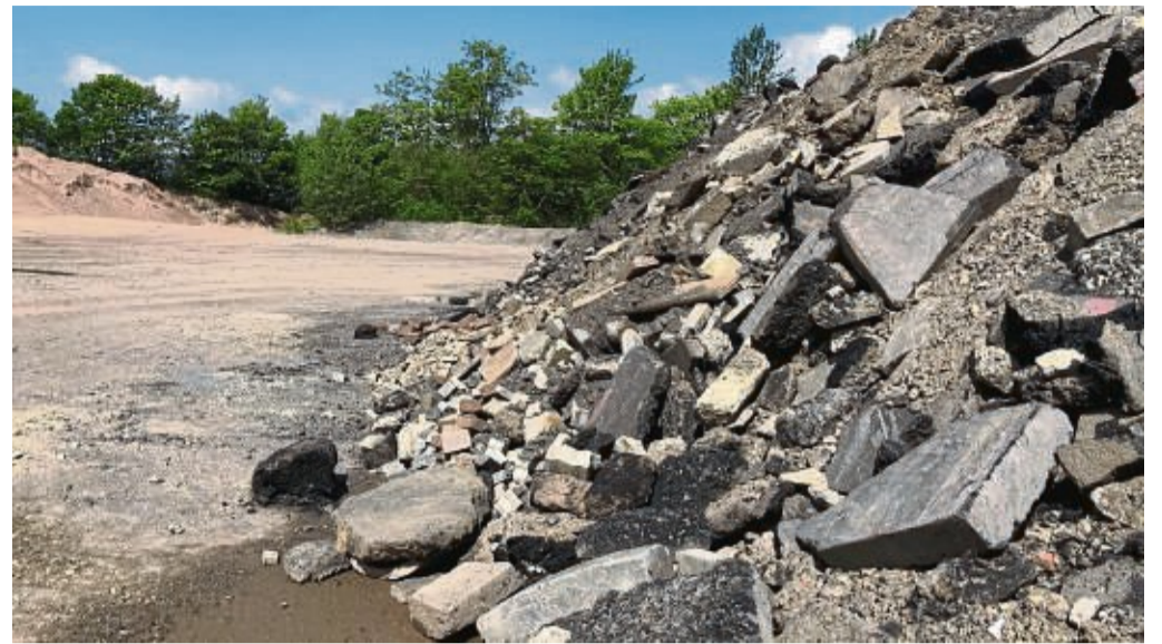
Bauschutt wird recycelt: Die Firma Baureka bereitet die Stoffe wieder auf, um sie über die Kreislaufwirtschaft im Straßenbau erneut nutzen zu können.
