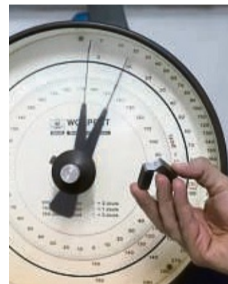
Zerstörerischer Effekt: Geprüft wird, mit wie viel Widerstand sich das Werkstück trennen lässt.
