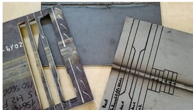
Verschiedene Stadien einer Probe: Aus einer Arbeit werden unterschiedliche Teile ausgeschnitten und dann auf Herz und Nieren überprüft.
