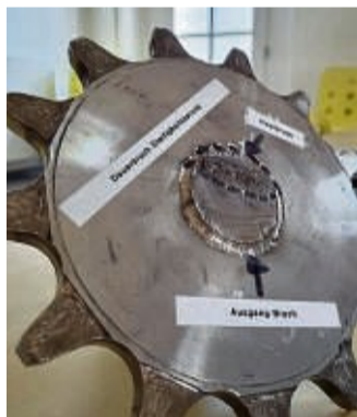
Das Anschauungsobjekt zeigt , wo die Schweißnaht zuerst nachgegeben hat.
