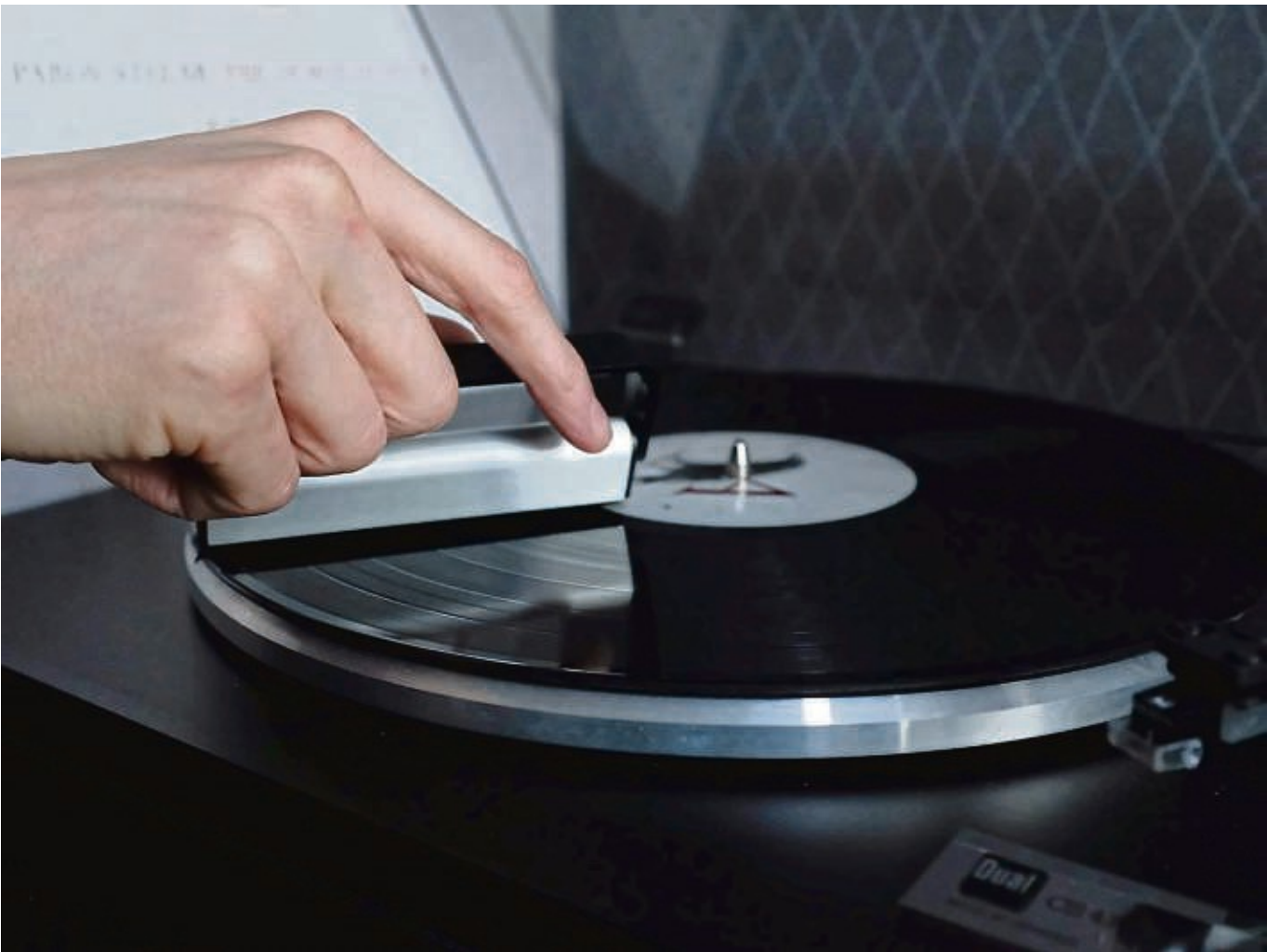
Sauber für unter 10 Euro: „Für die einfache Reinigung sind Carbonbürsten die beste Wahl“, rät Hi-Fi-Experte Herbert Bisges.
