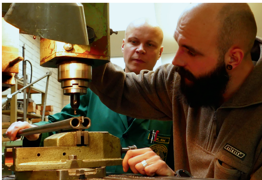
Fräsarbeiten an Doppelflintenlauf
