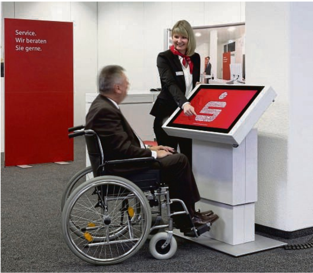
Für Rollstuhlfahrer ist es wichtig, dass sie einen Bankschalter oder einen Geldautomaten unterfahren können.
