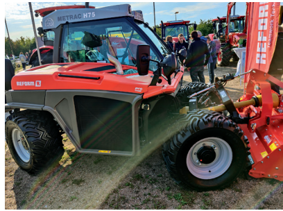
Metrac H75 – ein Hangtraktor speziell zur bodenschonenden Bergwiesenbewirtschaftung (Foto: Herrmann)
