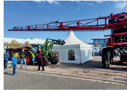
Spezialtraktor mit zwei 12 m-Auslegern für Flüssigdünger oder Herbizide (Foto: Herrmann)
