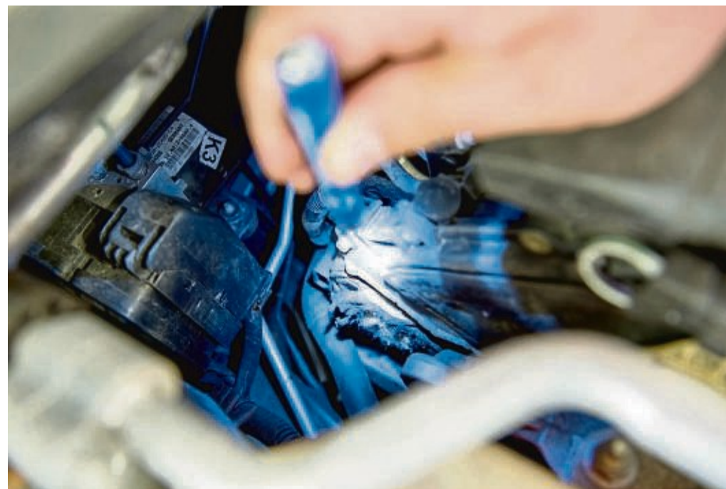
Sieht stark nach Marderbesuch aus. Angefressene Schläuche und Abdeckungen sind stumme Zeugen des nächtlichen Marderwütens im Motorraum.
