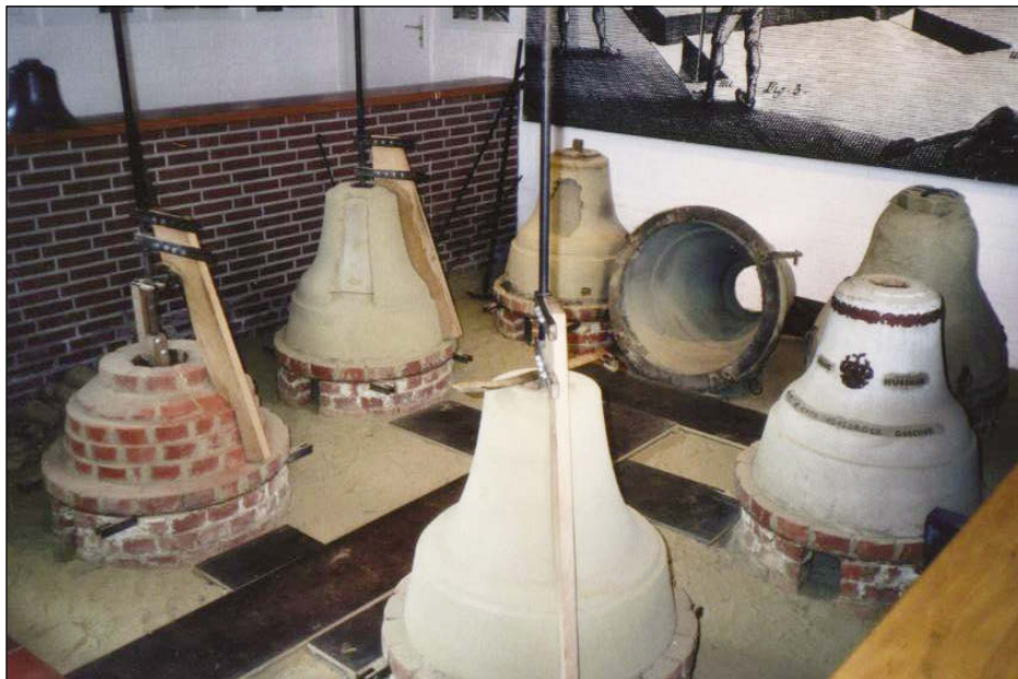
Fertigungsphasen beim Glockenguss: (v.l.n.r.) vom Glockenkern mit Rippenschablone bis zur Zierlehmschicht mit Inschrift (Quelle: Andreasdziewior - Wikipedia Commons)
