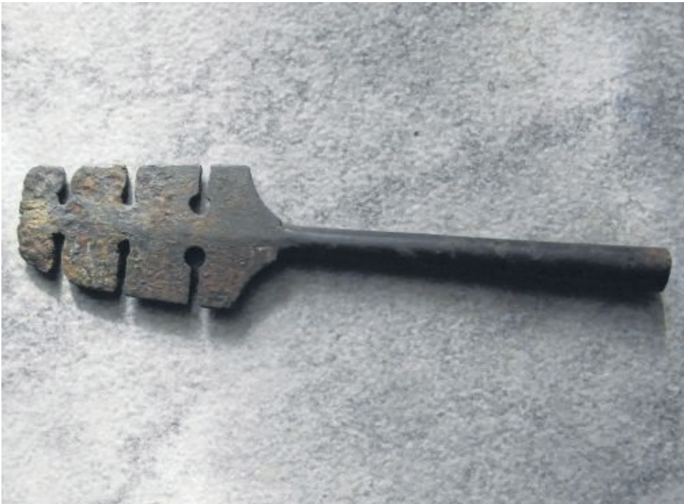
Ein Schränkeisen um 1900: Das Schränken erleichtert die Bewegung der Säge im Schnitt, vermehrt aber den Schnittverlust.
