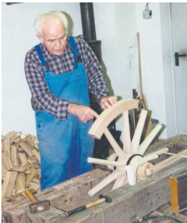
Stellmacher Kurt Rössing , Kerspenhausen, beim Anpassen einer Felge auf die Speichen (Aufn. Miehe 2010).
