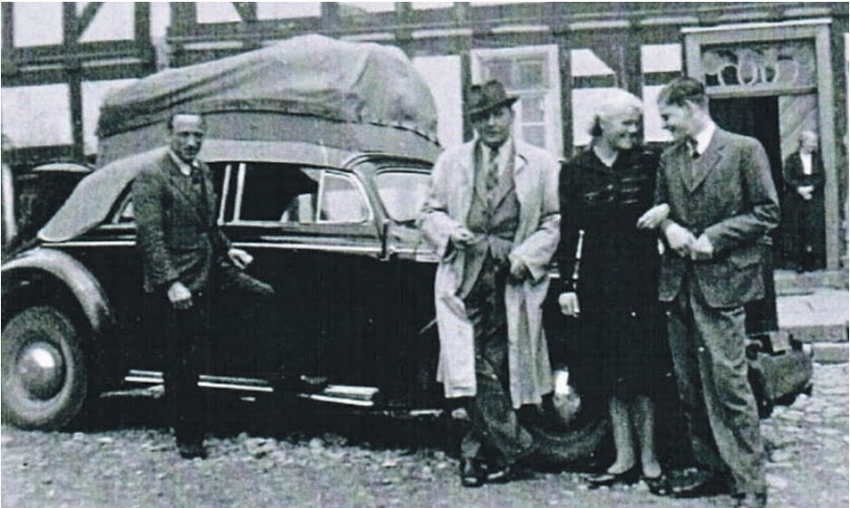
Auto mit Holzvergaser auf dem Hofgut Reinhard in Landershausen 1943. Zu erkennen sind im Heck der Heizkessel und auf dem Dach ein Sack mit Holzklötzchen (Juni)
