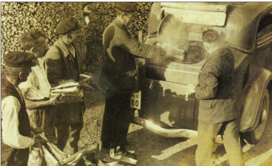
Beladen eines Holzvergasers mit Ofenholz im Kesseltal bei Friedewald.
