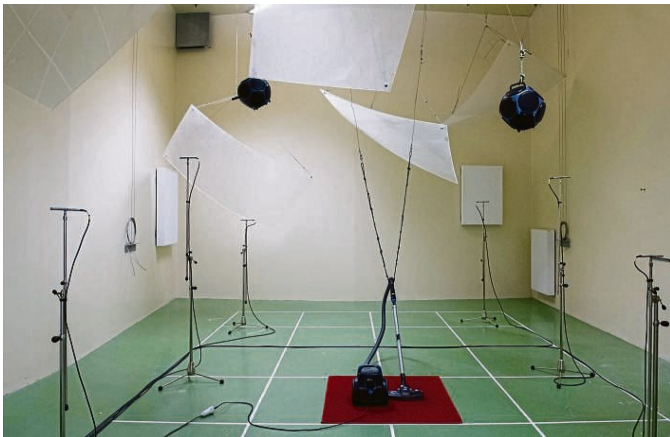
Ein Staubsauger steht im sogenannten Hallraum, in dem der Schall durch harte Wände und spezielle Segel verstärkt wird. Es gibt dazu auch ein Gegenstück, gleich nebenan: einen schalltoten Raum, in dem es quasi keinen Hall gibt.
