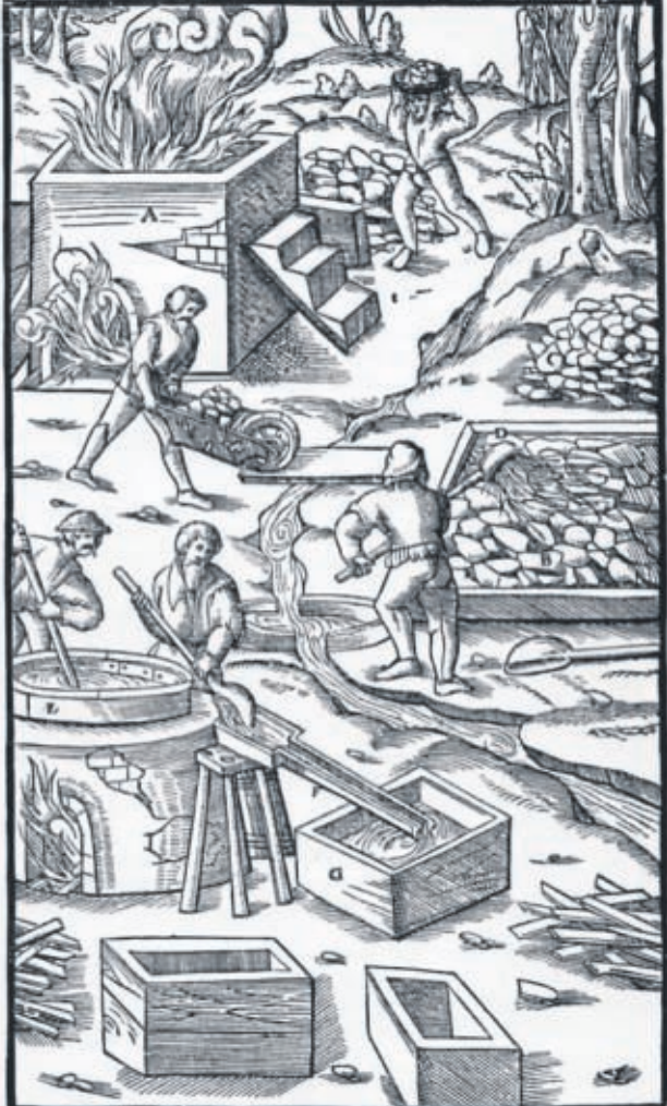
7 u. 8 Herstellungsprozess von Alaun. Holzschnitte aus Agricola 1556, Teil 1 (links), Teil 2 (rechts).
