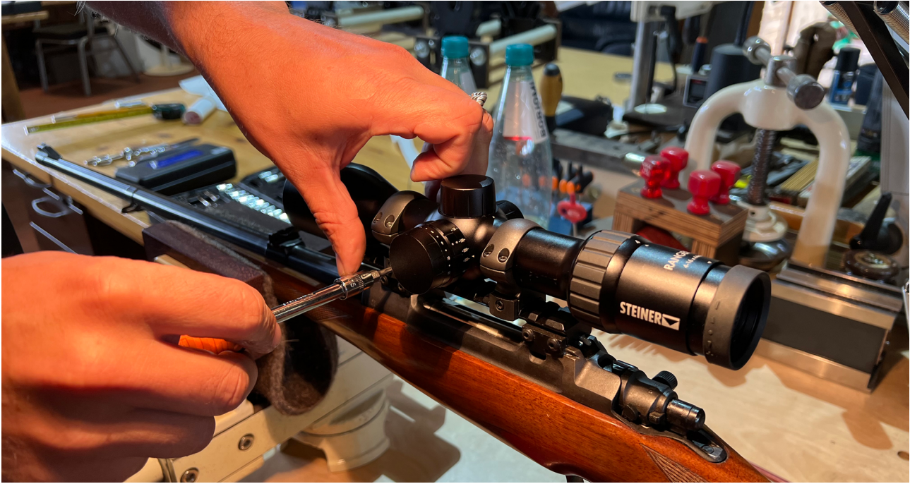
Wegen des bauartbedingten kurzen Mittelrohrs muss bei der Montage sehr exakt gearbeitet werden.
