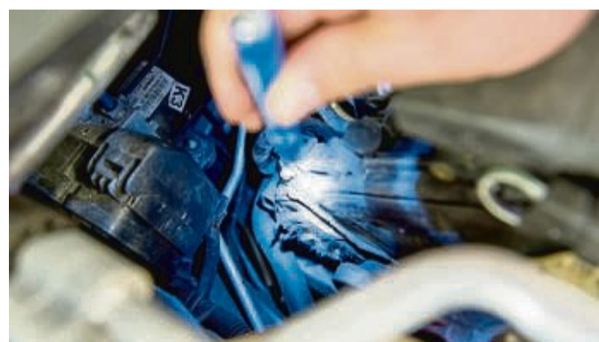
Angefressene Schläuche oder Abdeckungen können das Werk eines Marders sein.
