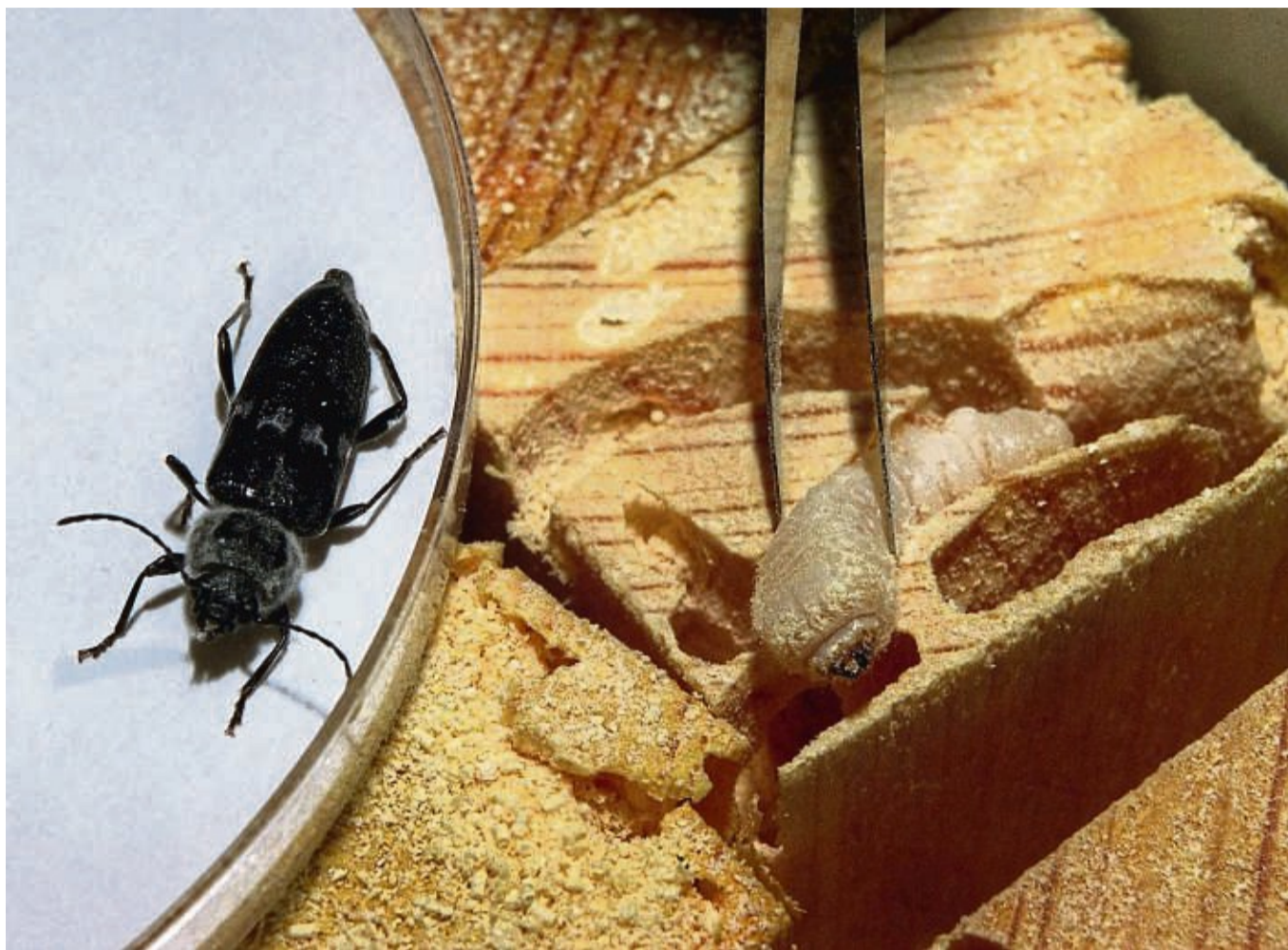
Auch die Larven von Hausböcken können Fraßschäden im Holz verursachen.
