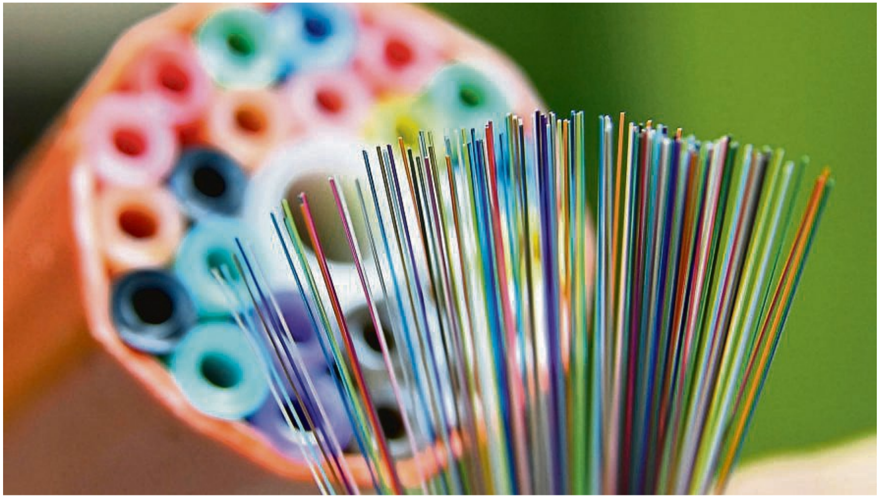
Ein Kabelbündel aus Glasfaserkabeln vor einer sogenannten Speedpipe (Leerrohr) für ein Glasfasernetzwerk.
