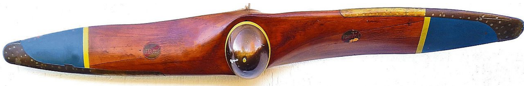
Der 215 cm lange und gut 10 Kilo schwere Propeller.
