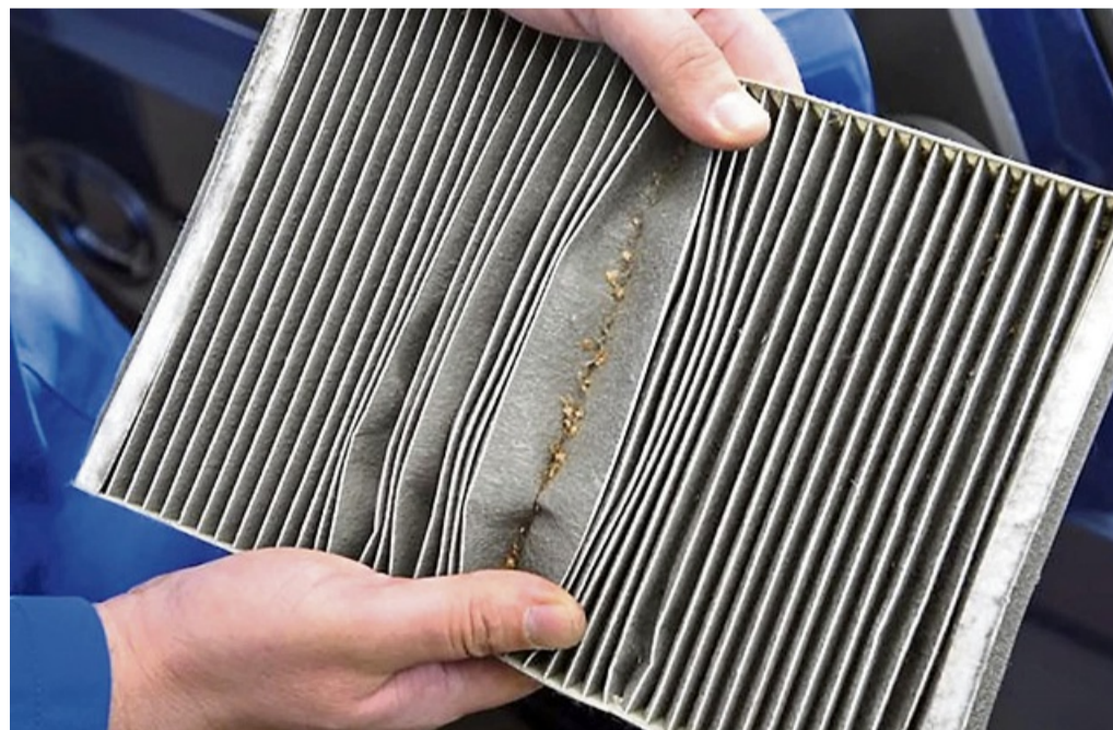
Der Innenraumfilter sollte mindestens einmal jährlich getauscht werden. FOTO: PROMOTOR
