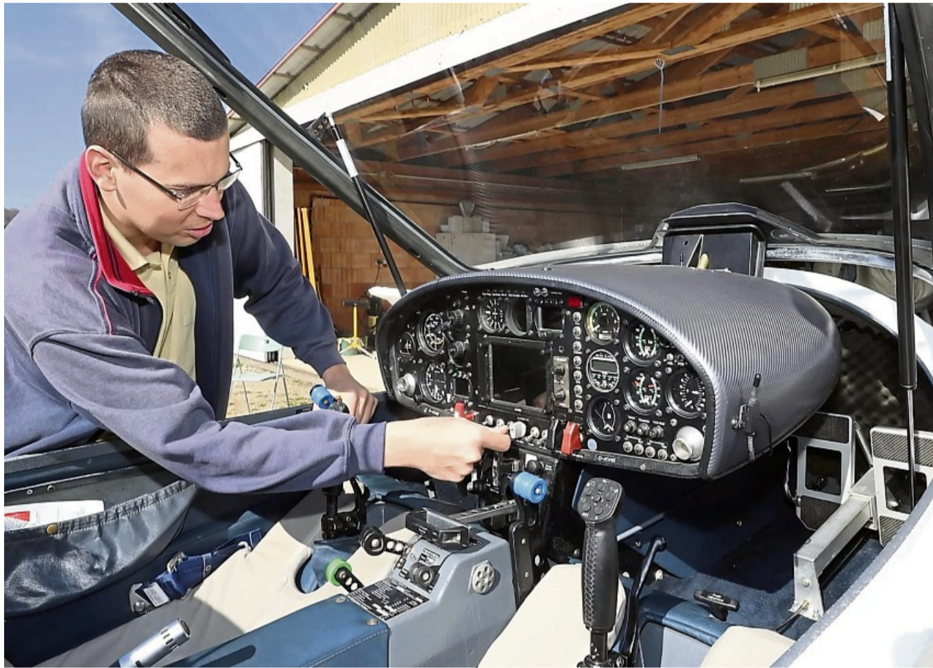
Vor dem ersten Start des Jahres überprüft LSV-Vorstandsmitglied Thomas Meder noch einmal die Elektronik eines der vier vereinseigenen Segelflugzeuge.
