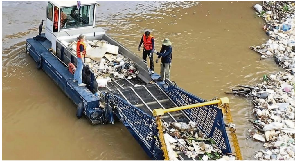
Müllboot im Einsatz ins Südostasien: Diese Sammelboote wurden eigens zum Sammeln von Plastikmüll entwickelt. FOTO: EVERWAVE/NH
