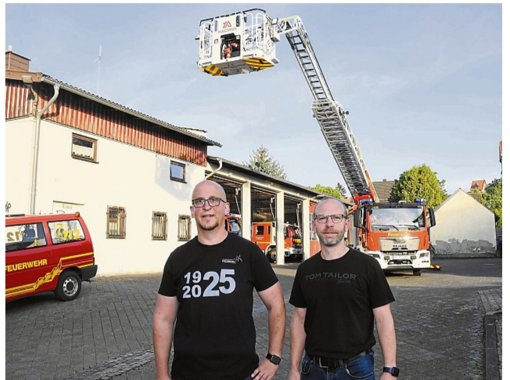
Beeindruckende Technik: Marco Häfele vom Festausschuss (links) und der stellvertretende Wehrführer Jens Ebert sind stolz auf die neue Drehleiter, die offiziell am Festwochenende übergeben wird. Die Leiter kann abgeknickt werden und so über ein Dach fahren.
