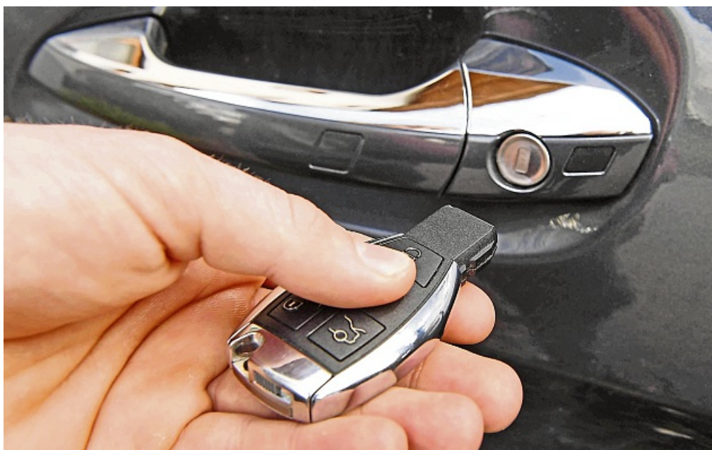
Praktisch – aber manchmal riskant: Signale von gewissen Funkschlüsseln lassen sich von Kriminellen blockieren oder weiterleiten.
