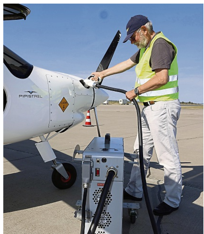
Anstatt Kerosin gibt es Strom: Markus Vogt vom Green Aviation Hub klemmt den E-Flieger an eine mobile Ladesäule.
