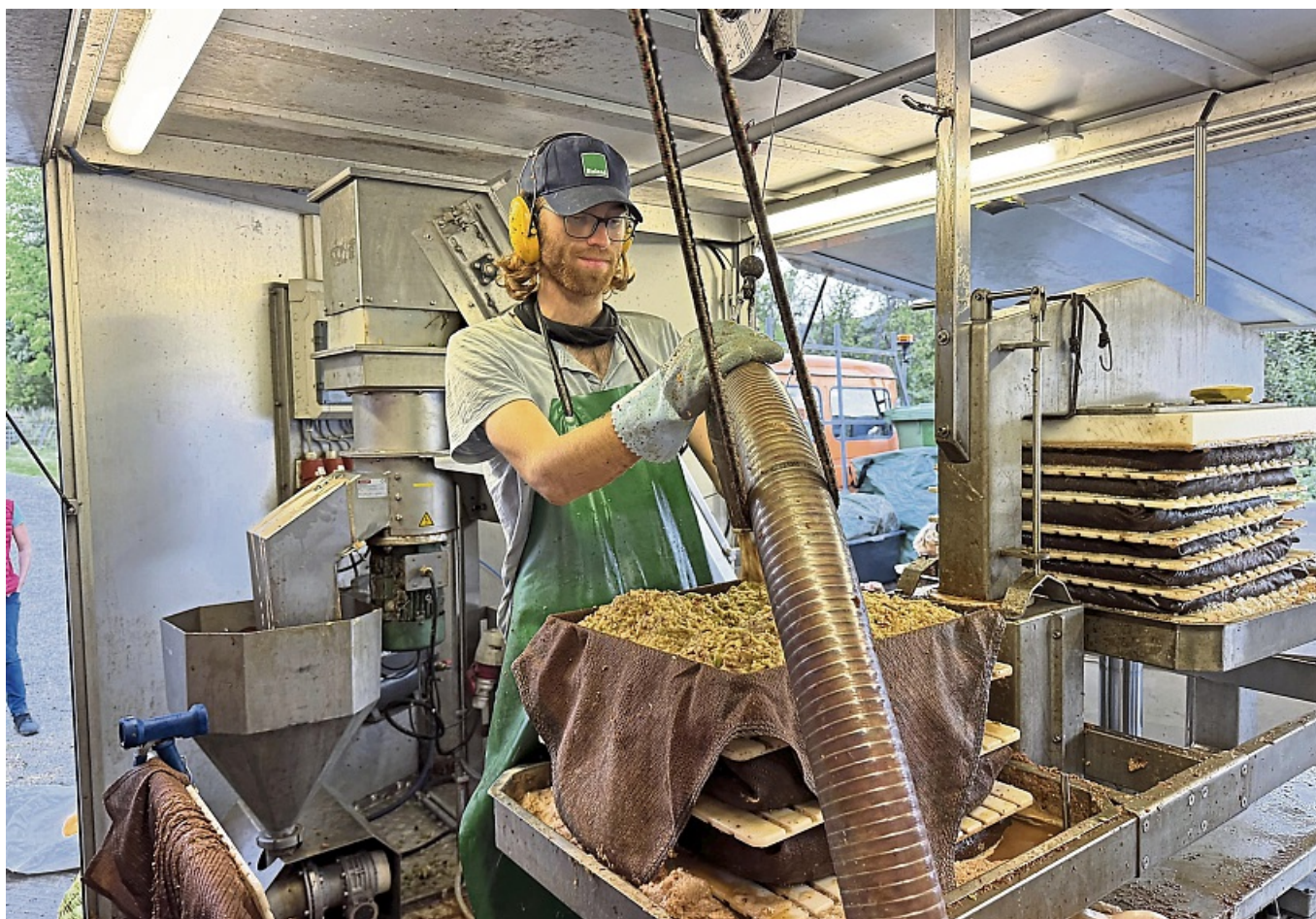
Nach der Zerkleinerung wird die Maische gen Presse gepumpt: Elias Gruber befüllt die Pressrahmen. FOTOS: CHRISTIAN MÜHLHAUSEN
